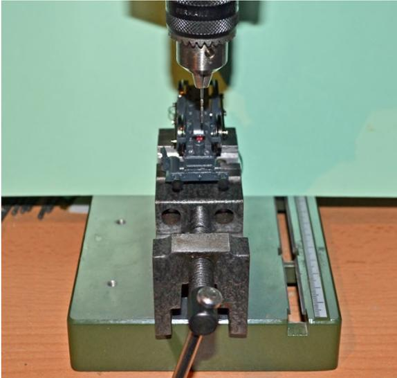
Die Schraube für Vorlauf 85724 lösen und ausdrehen, dabei die Feder 86215 nicht verlieren. Vorlaufgestell 138445 abnehmen.
