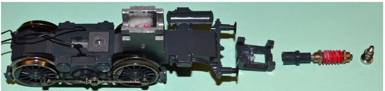
die Drehgestelle durch lösen der Drehgestellschraube 85703 vom Grundrahmen abschrauben, dabei die Drehgestellfeder 86229 nicht verlieren.
