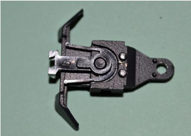
Das Vorlaufgestell demontieren, die Standard Kupplung entfernen und die Schwalbenschwanzaufnahme einsetzen. MK1h Universalkupplung in den Schwalbenschwanz einführen bis die Führungen oben bündig sind, Pfeil Blau.
