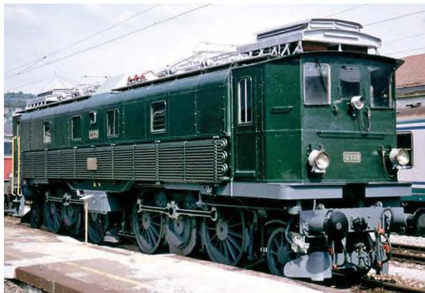
Die Be 4/6 der Serienausführung wurde als Schnellzuglokomotive für den Betrieb auf der Gotthardbahn gebaut. Konzeptionell war sie eine Drehgestellokomotive und entsprach im mechanischen Teil weitgehend der Probelokomotive Fb 2x2/3 11302. Anders als diese wurde sie dann auch tatsächlich längere Zeit am Gotthard eingesetzt.
