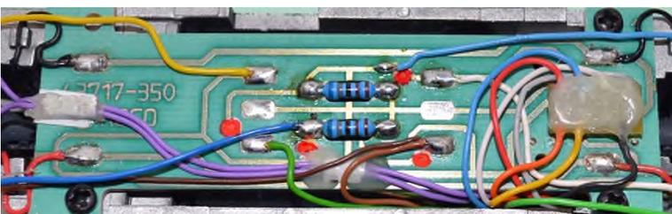
Die Beleuchtungslitzen wie im Bild sichtbar auf die Löt pads der Platine löten.
