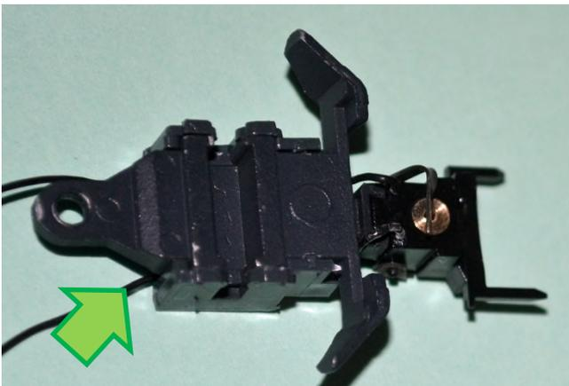
Kleine Schlaufen bilden und die Litzen nach hinten durchführen. Vorlaufdeckel einrasten und den Radsatz einsetzen.
